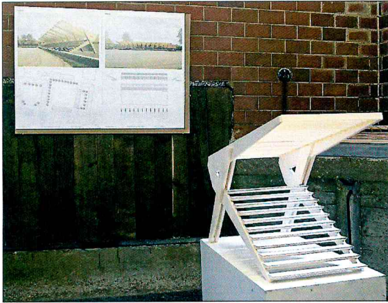
Prinzip Klappstuhl: Durch die geschickte Anordnung der Haupttragerelemente wurde eine Tribüne entstehen, die Sitzbereich und Überdachung in einer schlüssigen Formensprache vereint und ein freies Sichtfeld bietet. Denn: Laut Entwurf kommt das Bauwerk ohne Stützen im vorderen Bereich aus.
