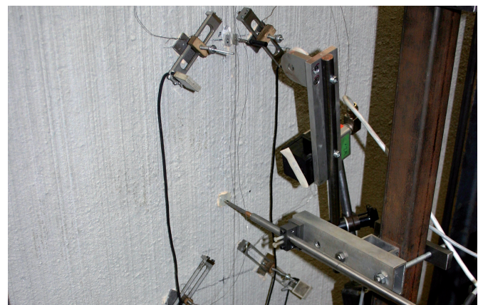
Bild 15. Dehnungs- und Verformungsmessung in Wandmitte Fig. 15. Measurement of strain and deformation in the middle of the element
