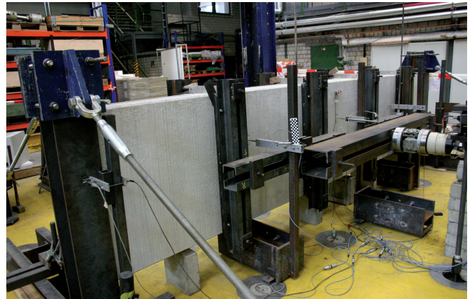
Bild 4. Versuchsstand mit Versuchskörper (l = 5 m), Rückansicht Fig. 4. Experimental set-up with test specimen (l = 5 m), back view
