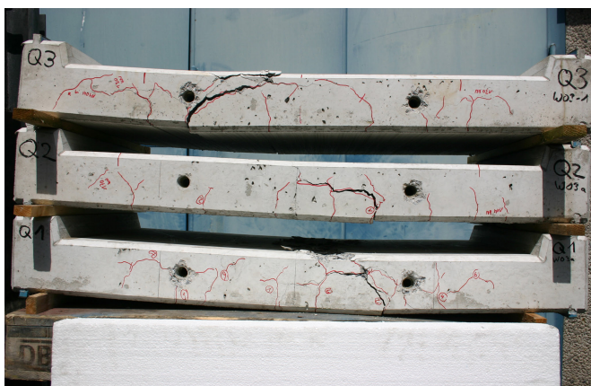
Bild 14. Versuchskörper Q1 bis Q3 nach Versuchsdurchführung mit Biegeversagen Fig. 14. Test specimen Q1 to Q3 after test with bending failure
