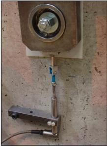
Nach der Auswertung und Analyse der Versuchsdaten konnten diese in einem Kraft-Verformungsdiagramm gegenübergestellt und Approximationsfunktionen ermittelt werden. Mit Hilfe dieser Funktionen war es möglich die Versuchsergebnisse bei einer bestimmten Bezugsverformung auch unter Berücksichtigung einer eventuellen Ankerplattenverformung ( $s_{cr} - s_{ucr}$ ) zu vergleichen.
