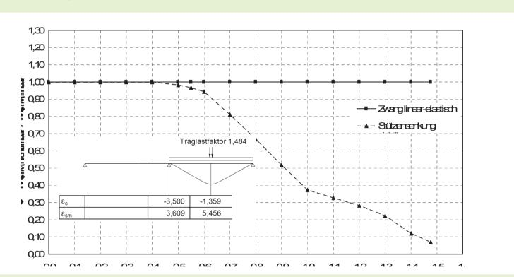
Der Einfluss einer Setzung auf die Größe der Systemtraglast ist relativ gering. Die normgemäße Einwirkung von  $\Delta_{\text{Set}}$ = 1,0 cm hat nur einen Einfluss von ungefähr 1 %. Somit ist dieser Einfluss auf die Größe der Systemtraglast nach nichtlinearer Berechnung vernachlässigbar.
